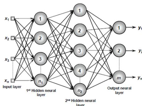
**Figura 1** - Exemplo de estrutura de uma rede neural de multicamadas (SILVA et al, 2017)
